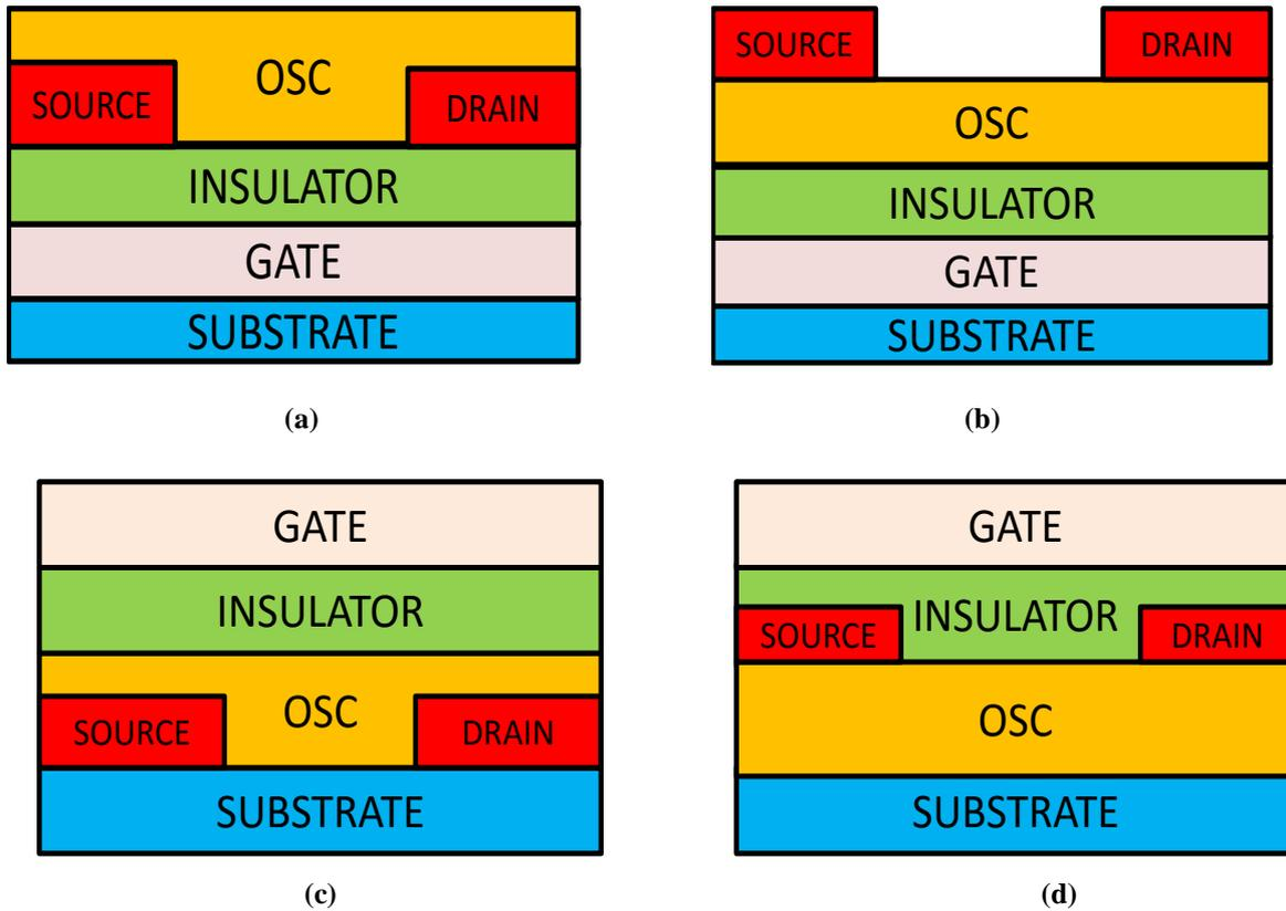
Figure 2.1 Structure of OTFT (a) BGBC (b) BGTC (c) TGBC (d) TGBC
